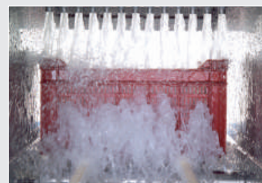
Limpieza de toberas de arriba hacia abajo
